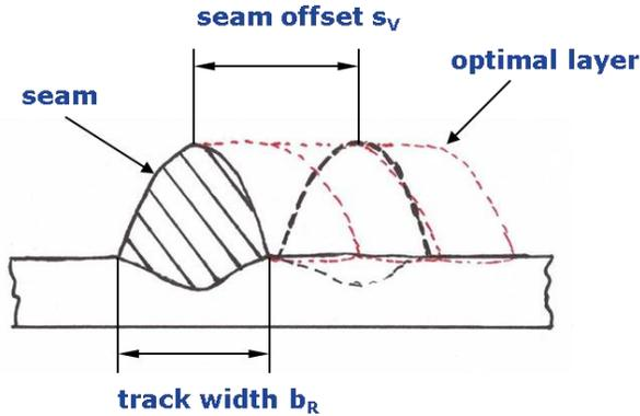
**Fig. 3:** Geometrical layer parameters
