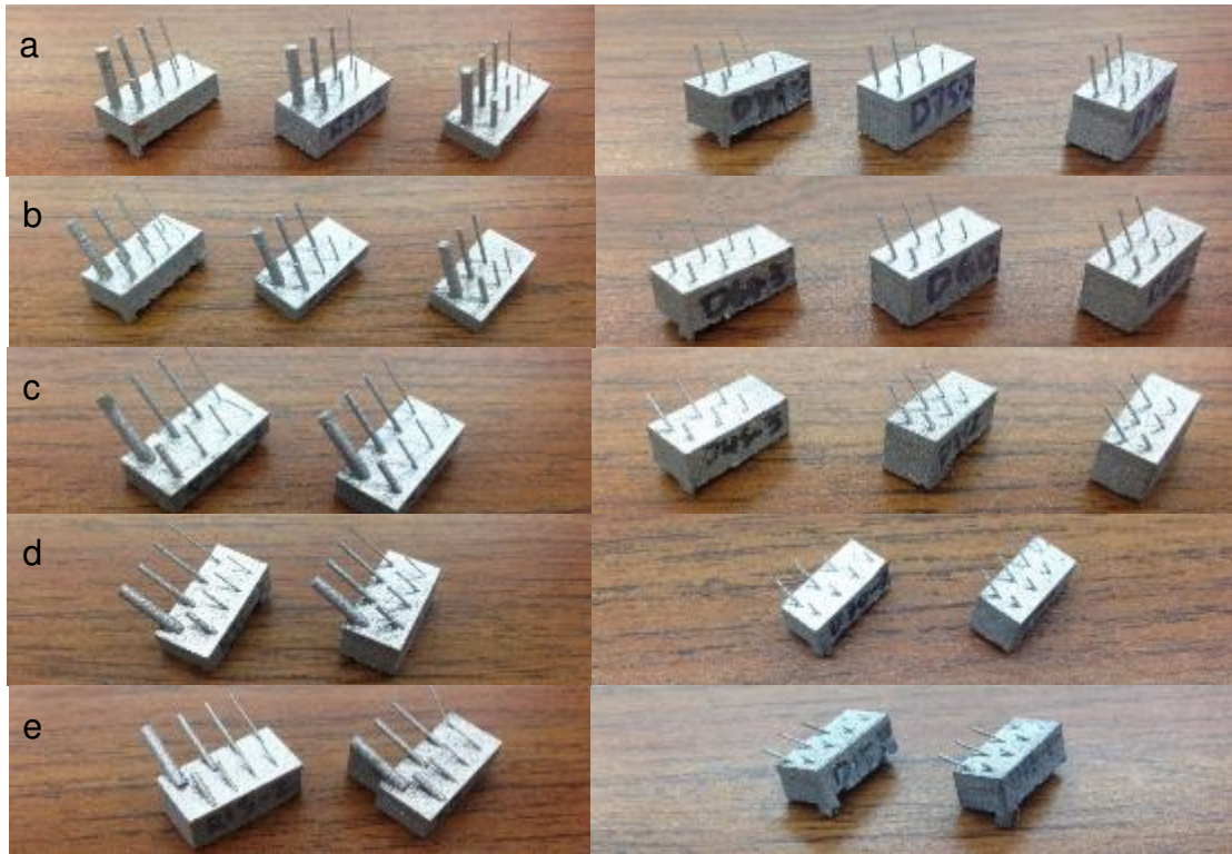
Fig. 4 1 st build samples, a. 75°, b. 60°, c. 45°, d. 30°, e. 15°
